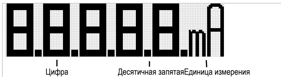
Рисунок 4: Режим измерения - дисплей без гистограммы
