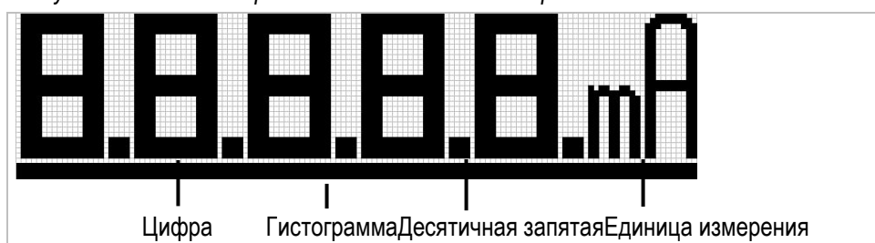
Рисунок 5: Режим измерения - дисплей с гистограммой
